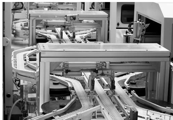
Die Zuführung zu den Schleifmaschinen erfolgt über zahlreiche Förderstrecken.
