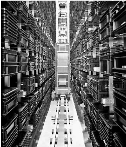
Die RBGs erreichen Fahrgeschwindigkeiten bis 4 m/s.
