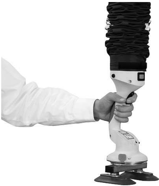
Die Bedienung des JumboFlex über den ergonomischen Griff erfordert nur eine Hand.
