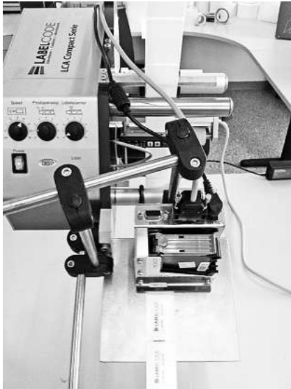
LCC Micron eingebaut in Etikettiergerät LCA Compact Serie.
