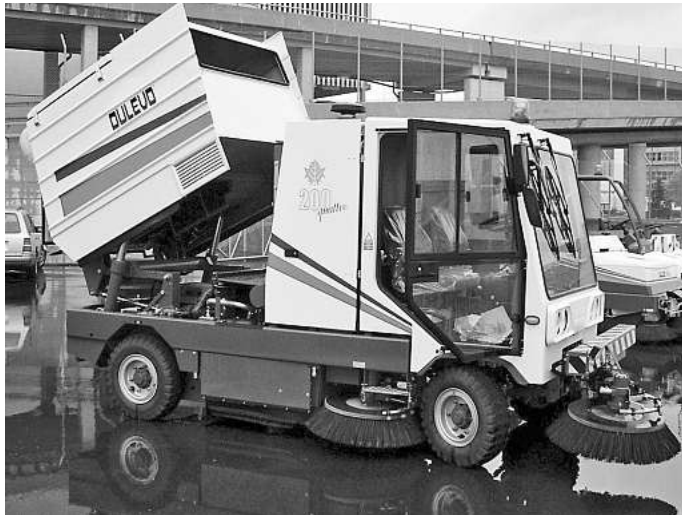
Schmutzbehälter wird zur Entleerung hochgefahren.
