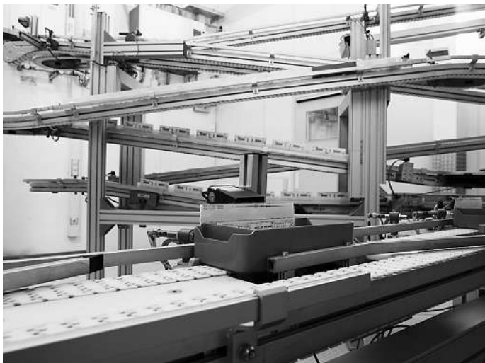
Achtung Vorfahrt! Nach der Veredelung fahren die Brillengläser über den Wendepuffer zur Prüf-Station. Eilaufträge überholen die Warteschlange.
