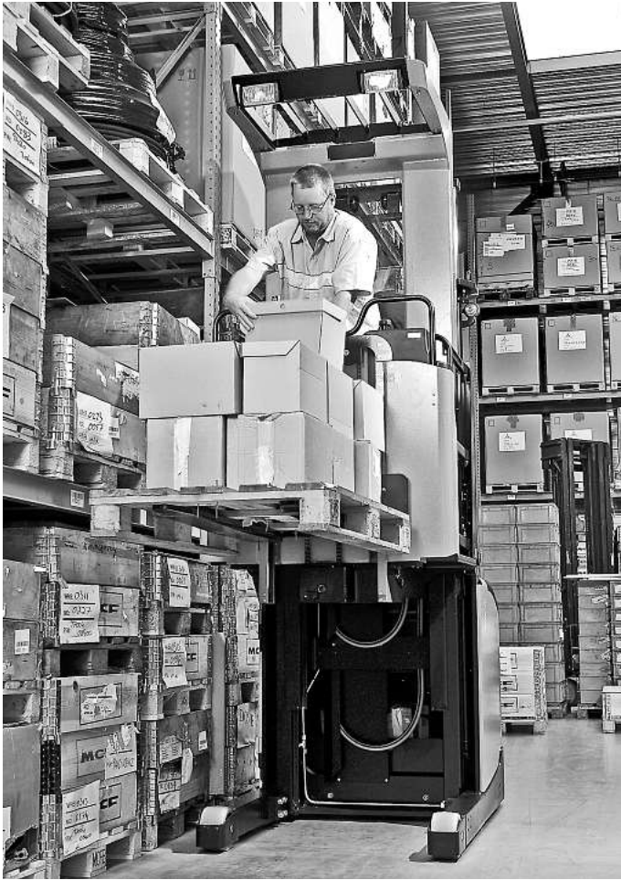
Mitsubishi Gabelstapler ist ein echter Fördertechnik-Full-Liner. Neben den Gabelstaplern produziert Mitsubishi auch alle Lager- technikeräte wie diesen Kommissionierer für mittlere Höhen.
