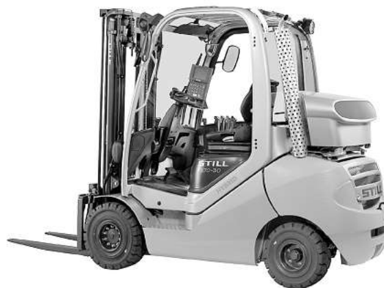
Der neue STILL Dieselstapler RX 70 mit Hybridantrieb.
