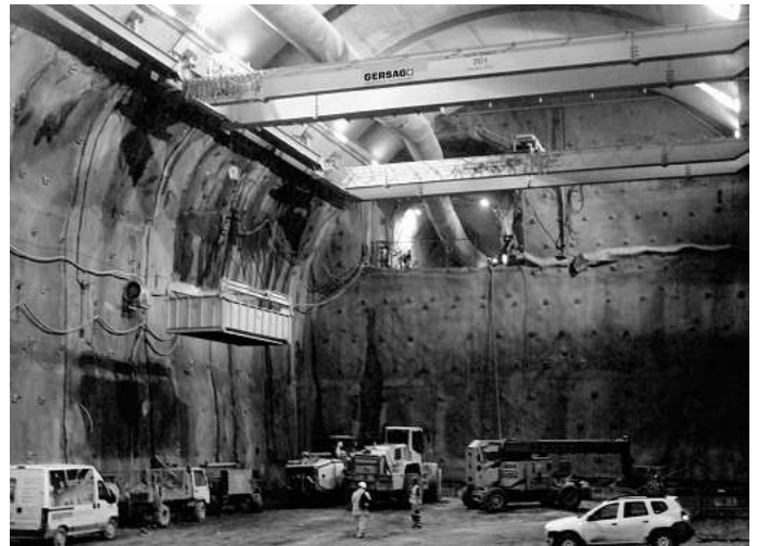
Zweiträger-Brückenkrane in der Betonanlage. An der linken Brücke ist der Stoss der 2-teiligen Brücke ersichtlich.
